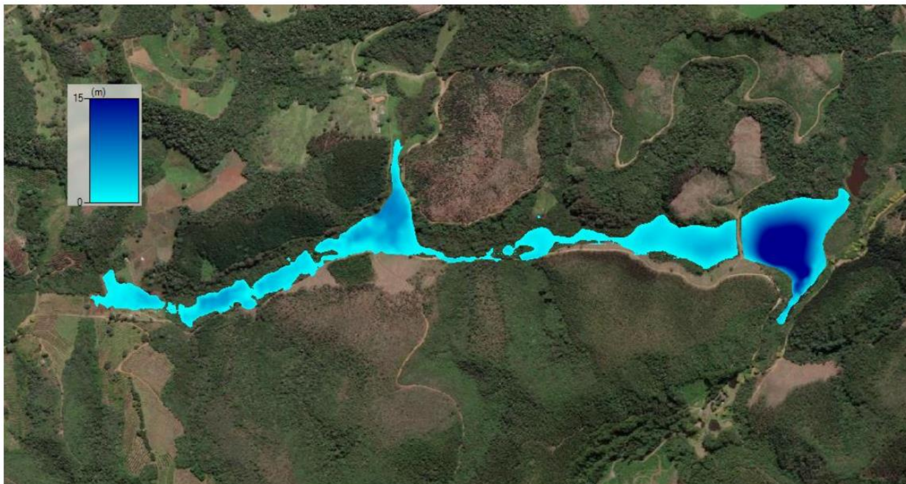
Imagem de satélite com sobreposição da modelagem no software HEC-RAS de ruptura hipotética simulando o rompimento por processo de galgamento: cenário final – perspectiva de profundidade. Fonte: NERY AMBIENTAL, 2023.
