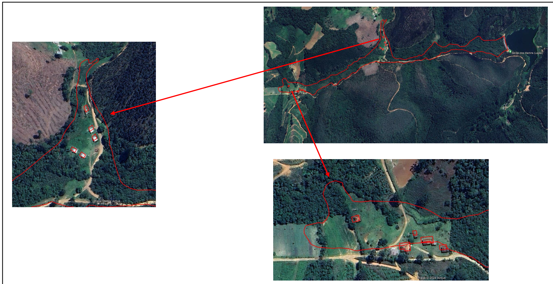
Imagem de satélite com polígonos da mancha de inundação e das edificações possivelmente a serem atingidas pela onda de ruptura inseridas na Zona de Auto Salvamento. Fonte: NERY AMBIENTAL, 2023.
